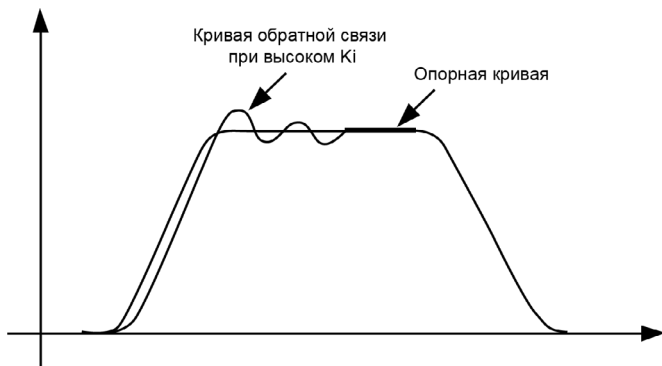
Рис. 6.31 - Влияние K_i на кривую обратной связи
